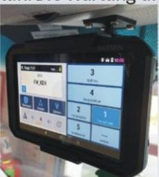
Damit die Kräfte der Feuerwehr Teugn bei einem Voraushelfereinsatz schnellstmöglich die Einsatzstelle finden, hat die Gemeinde kürzlich ein spezielles Navigationsgerät für das Mehrzweckfahrzeug beschafft. Zusammen mit der Alarmierung können nun von der Leitstelle die Adresse und die GPS Daten direkt an das Fahrzeug gesendet werden. Die Navigation zur Einsatzstelle startet vollautomatisch, was gerade bei Einsätzen in Nachbarorten wertvollste Zeit spart.
